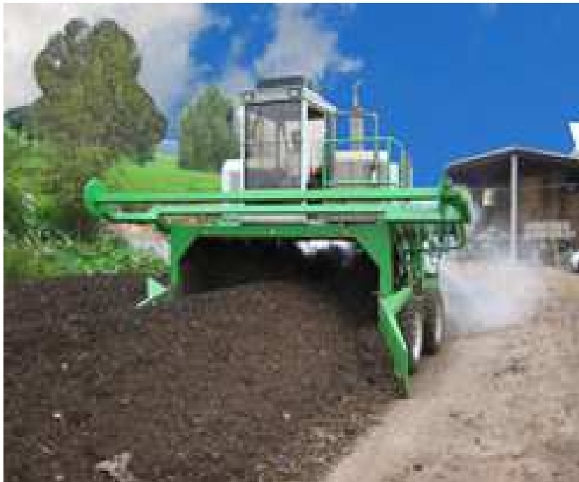
Ryc. 31 Przerzucarka COMPOPLAN – przeznaczona dla małych pryzm kompostu i niewielkich ilości - przykład
