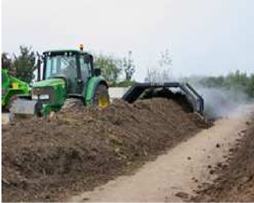
Ryc. 31 Przerzucarka COMPOPLAN – przeznaczona dla małych pryzm kompostu i niewielkich ilości - przykład
