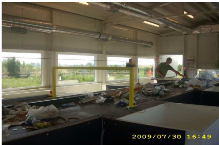
Ryc. 15 Typowa linia sortownicza polskiej produkcji : źródło; Tugeb-Polbud
